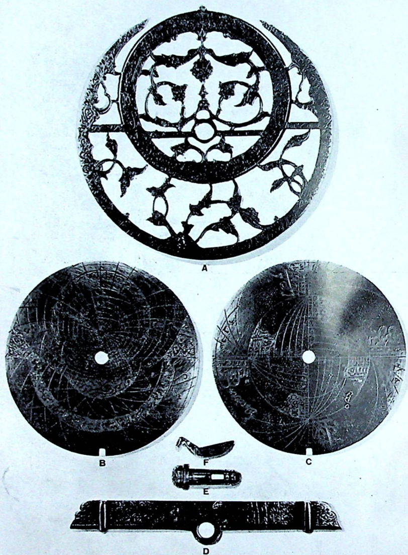
FIG. 4. — A : Araignée. — B. C : Tympan (Réduits aux 3/4). D : Alidade. — E : Pivot. — F : Clavette.
